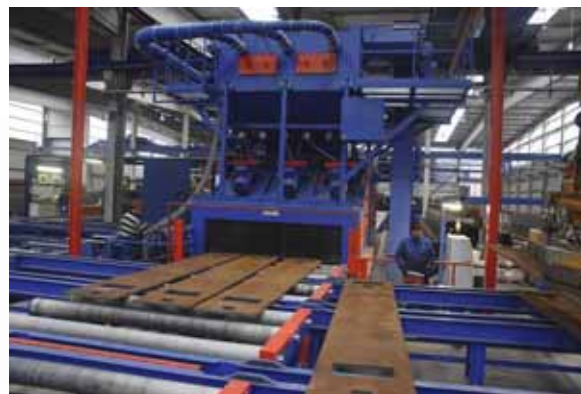
Otryskávacie prostriedok vrhá na diely spolu šesť vysokovýkonných lopatkových kolies typu Hurricane® H 42 s priemerom 420 mm a hnacím výkonom každého kolesa 22 kW. Vďaka vysokej intenzite otryskávania sa hodnota čistoty SA 2,5 dosahuje spoľahlivo, so schopnosťou stálej reprodukcie a hospodárne.
